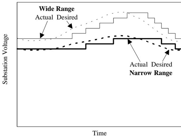
Fig. 4. Desired and actual voltages.
